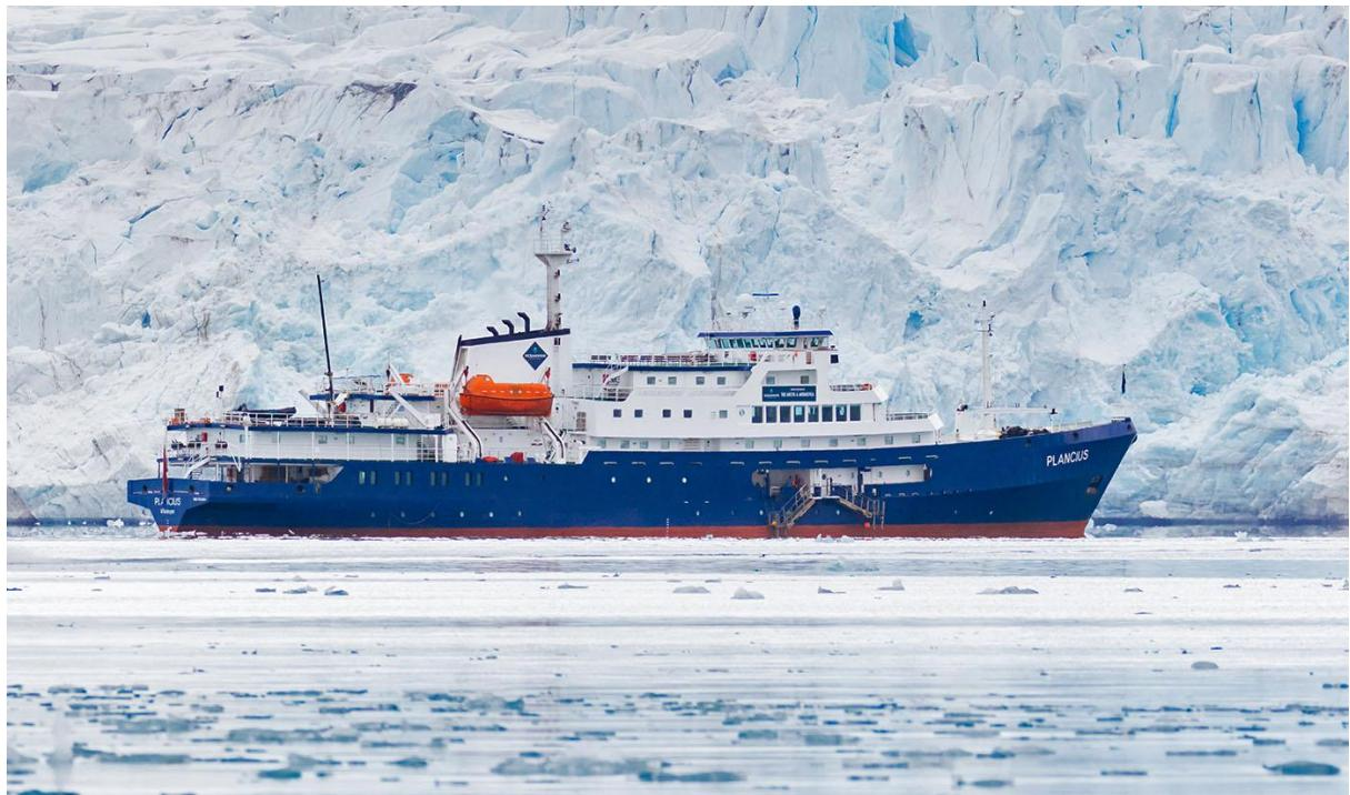
Die M/v Plancius wurde 1976 als ozeanografisches Forschungsschiff für die Königlich Niederländische Marine gebaut und erhielt den Namen „Hr. Ms. Tydeman“. Das Schiff wurde 2009 komplett zu einem Passagierschiff umgebaut und entspricht den neuesten SOLAS-Vorschriften (Safety Of Life At Sea). Die M/v Plancius ist 89 m lang, 14,5 m breit und hat einen maximalen Tiefgang von 5 m, Eisklasse 1D, eine durchschnittliche Reisegeschwindigkeit von 10,5 Knoten und verfügt über 3 Diesel-Elektromotoren.
